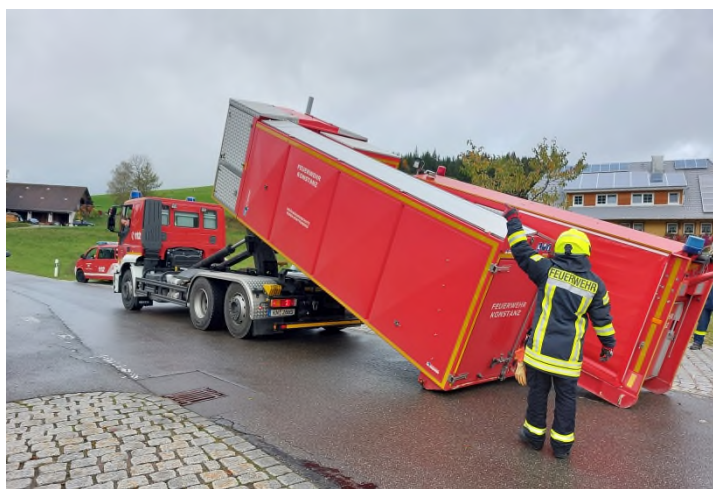
Abrollbehälter Hytrans Fire System (AB-HFS)
